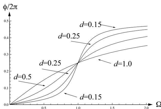
Abbildung 2: Grafische Darstellung von  $\phi(\Omega, d)/2\pi$ , also der zeitlichen “Verspätung”  $\phi(\Omega, d)/\Omega$  der Systemantwort gegenüber der Anregung, gemessen in der Periode  $T = 2\pi/\Omega$  der Anregung als Einheit – für verschiedene Werte von  $d$ .
