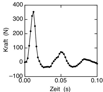
Die Messung mit der Apparatur von Abb. 2 ergab Kraftspitzen von 60 N, wenn der Wasserballon (0.48 kg) aus 1.0 m Höhe drauf fiel. Dies ergibt einen Druck von
