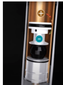
Fig. 2 Schéma d'une fourche à ressort pneumatique
